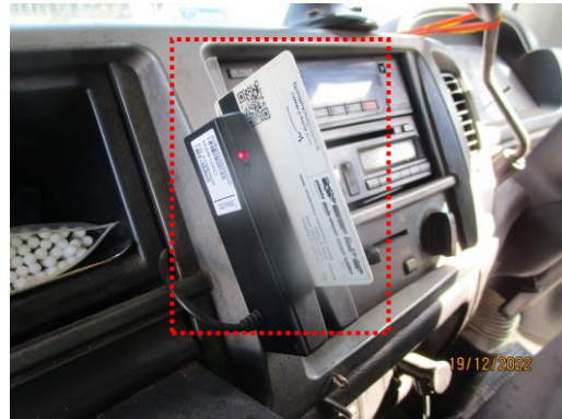
รูปที่ 3.33 การติดตั้งระบบ Global Positioning System (GPS) ที่รถขนส่งกากของเสียอุตสาหกรรม
